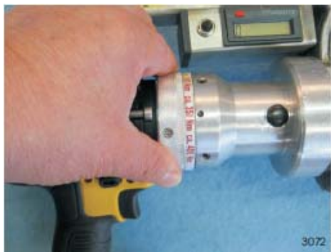
Gemakkelijk in te stellen slipkoppeling van ca. 50 - 00 Nm, direct afleesbaar.
