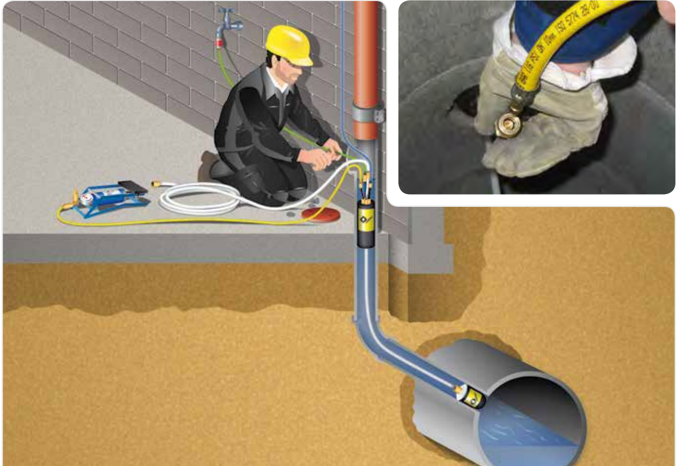
Waterdruk testen volgens DIN EN 1610 met het Vetter teststelsiem voor huissaansluitingen.
