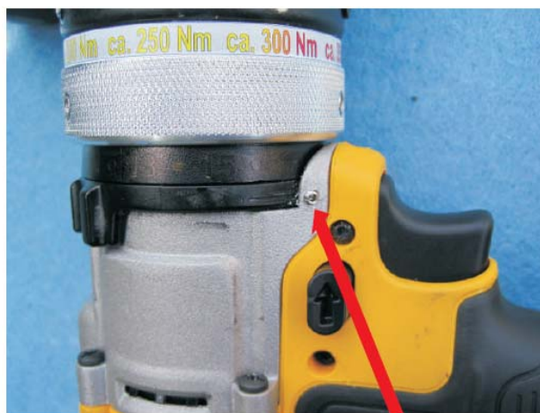
Ontgrendeling van de draaimomentbegrenzer voor reactiekrachten boven 400 Nm. (directe aandrijving zonder slipkoppeling). CE conform vergrendelingssysteem. Mag alleen met een sleutel ontgrendeld worden.
