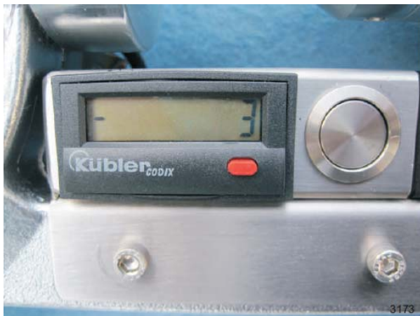
Elektronisch telwerk, optellend en aftellend, met resetknop
