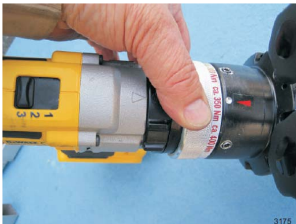
Gemakkelijk in te stellen slipkoppeling van ca. 50 - 400 Nm, direct afleesbaar
