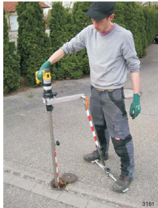
Stabilisatie door RVS voetframe voor uiterst gebruiksvriendelijke bediening (tot 400 Nm CE conform)
