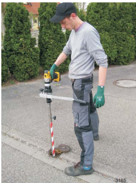
Stabilisatiesteun met handgrepen. Ook door tegenaan te leunen te gebruiken. Voor bediening door 1 persoon (tot 300 Nm CE conform)
